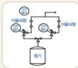
3Way Valve 복수 방식으로 안전밸브를 설치한 경우
